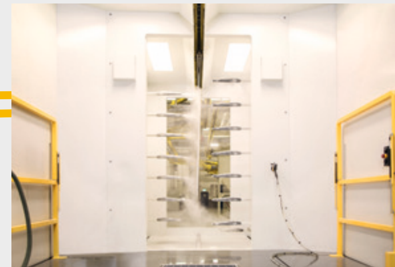
Vollautomatisierte Anlage, Bauteilgröße max. 4x1,2x2,5 m
